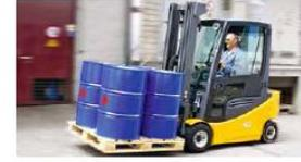
Beim innerbetrieblichen Transport von Gebinden besteht die Gefahr, dass diese beschädigt werden. Befindet sich in den Gebinden leichtbrennbare Flüssigkeit, können auslaufende Stoffe zu Gesundheitsschäden, Bränden und Explosionen führen.
